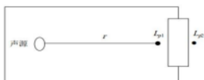
图 4-3 室内声源等效为室外声源图例
