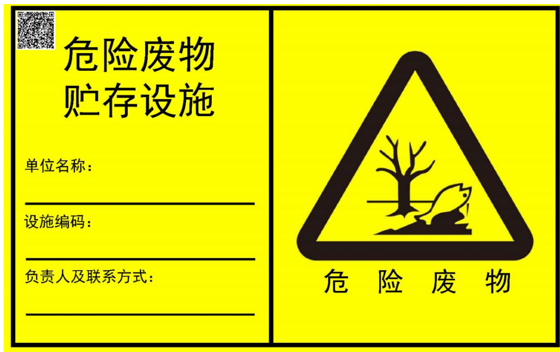
图 4-3 危险废物贮存设施标志（横版）
