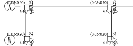
图 5.2.22 C 区七层轴压比简图
