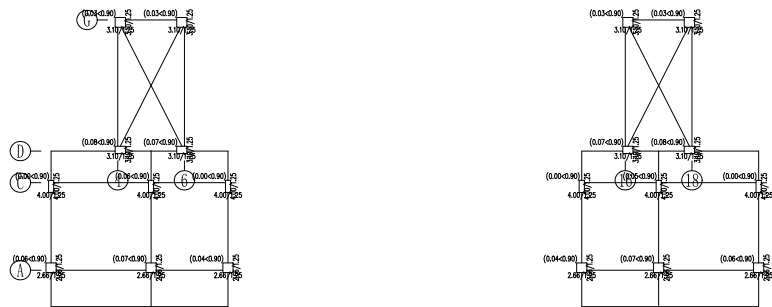
图 5.2.20 A 区七层轴压比简图
