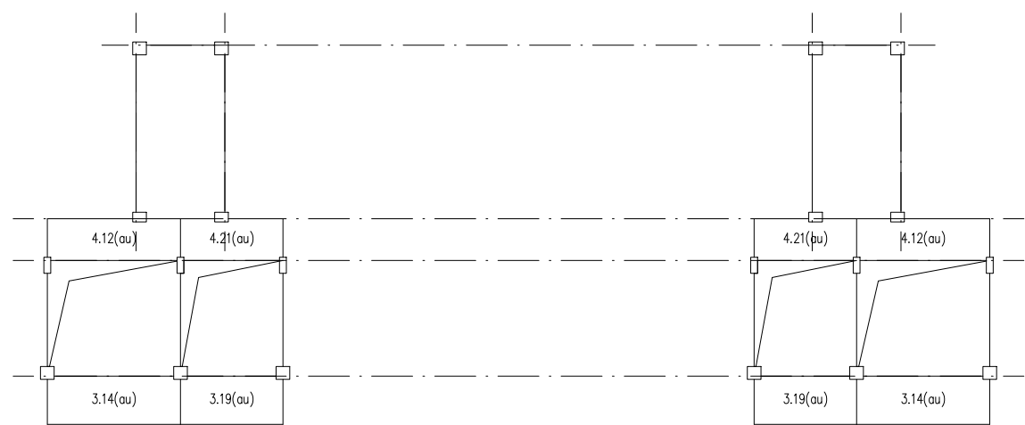
图 5.2.65 A 区屋面构架层板安全评级结果简图（抗力与荷载效应之比）
